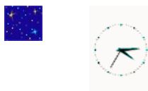
Рисунок 2.4. Изображения, указывающие на отсутствие синхронизации от спутников в области состояния прибора (слева) и в области управления прибором в автономном режиме (справа).
