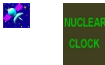
Рисунок 2.3. Изображения, указывающие на наличие синхронизации от спутников в области состояния прибора (слева) и в области управления прибором в автономном режиме (справа).
